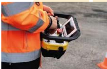
Sterowanie zdalne dla zapewnienia maksymalnej wygody obsługi (operatora).
